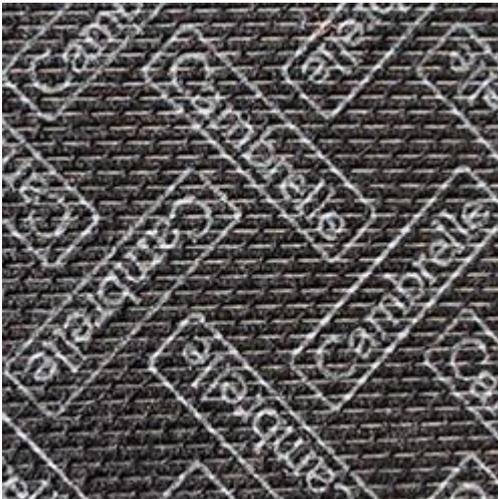
Cambrelle® ist ein hochwertiges synthetisches Vlies, das mit einer Faser hergestellt wurde, die speziell durch ein Verfahren hergestellt wurde, bei dem zwei Nylontypen miteinander versponnen werden. Dies ergibt eine extrem hohe Absorptionsrate und hervorragende Atmungsaktivität.
