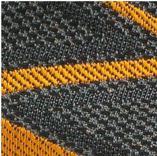
Neueste Technologien im hochfesten Nylongewebe. Eine speziell entwickelte Faser besteht aus einem einteiligen Obermaterial mit unterschiedlichen Texturen für verschiedene Funktionsbereiche. Extrem flexibel, atmungsaktiv, reiß- und abriebfest.
