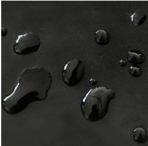
Für unsere GORE-TEX-Linie werden nur unsere besten Vollnarbenleder verwendet, die sorgfältig nach Atmungsaktivität und Wasserbeständigkeit ausgewählt wurden. Die Konformitätsprüfung ist äußerst streng: Ein kleines Stück Leder, das 2 Stunden lang zur Hälfte in Wasser getaucht ist, kann kein Wasser mehr als 10 mm in Richtung des trockenen Bereichs ziehen.
